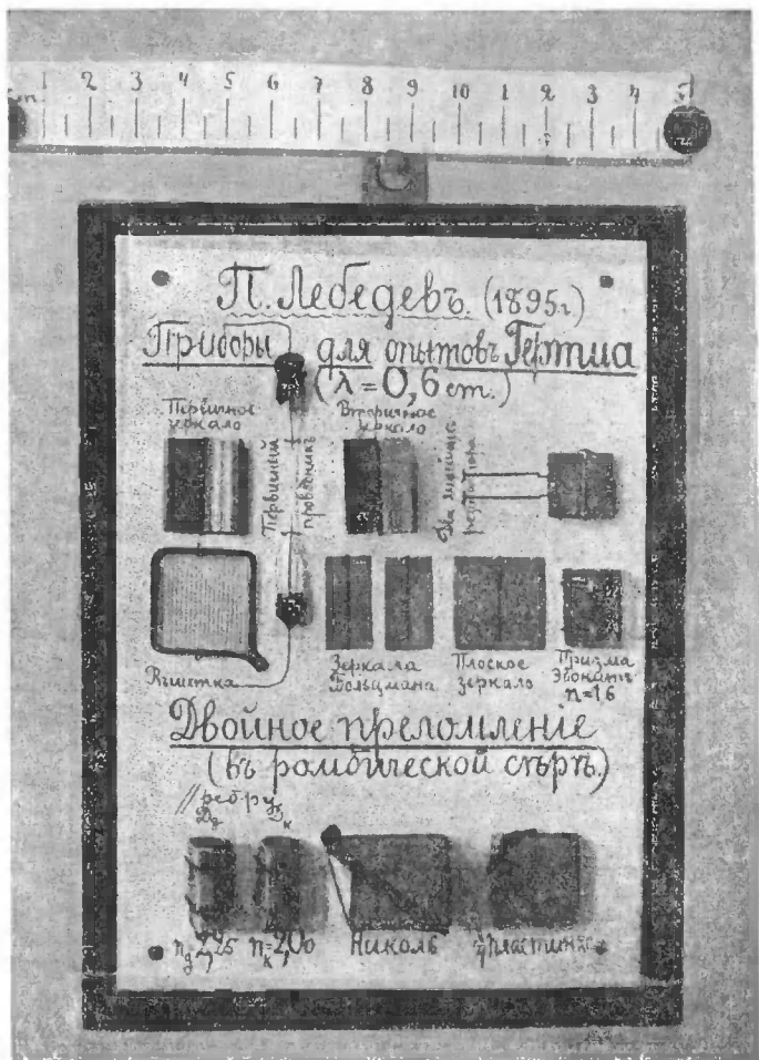
Фиг. 1. Приборы П. Н. Лебедева, служившие для опытов с короткими волнами Герца. Наверху сантиметровый масштаб. Над отдельными приборами собственноручная надпись П. Н. Лебедева.
